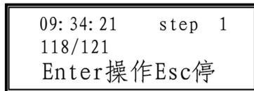
查看连接的设备、阀门是否符合工艺要求，确认后再按下(ENTER)键进入主程序的第二步。示屏显示与第一步相似。依次进行所有步骤，并查看连接的设备、阀门动作是否符合工艺要求。
