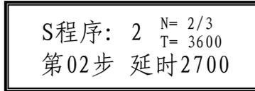
在“第00步”处按(ENTER)进入设定，用(◀▶)键与(▲▼)键来设定需要输出信号的步骤，其可设定步数范围不超过主程序的总步数。用(ENTER)确定。然后用(◀▶)键选择“延时0000”，按(ENTER)进入设定，用(◀▶)键与(▲▼)键来设定延时时间。延时时间最长不超过主程序中该步设定的时间，S2的延时输出在整个再生过程的过程中只能选择其中的某一步，而不能同时选择多步组合输出。
